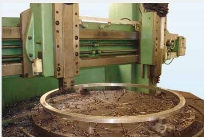
◎ 4.5米数控立式车床加工转鼓零件
