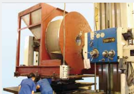
◎ 大型数控镗床整体加工轴承孔
